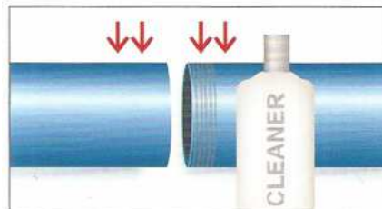
Rys. 3: Oczyszczenie przygotowanej powierzchni zgrzewania
