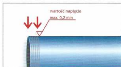
Rys. 2: Przygotowanie powierzchni zgrzewania za pomocą obrotowego skrobaka
